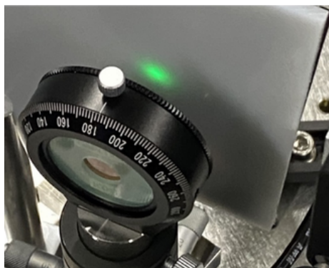
非線形光学結晶を透過した光が、目に見えない近赤外光から緑色の光になる第2高調波発生。
